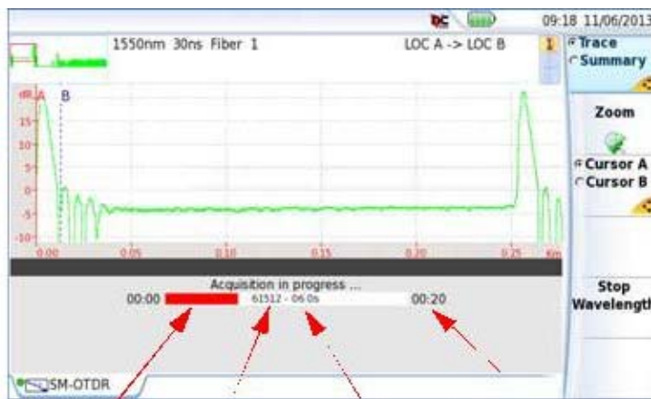
Рисунок 24 Выборка данных в режиме SmartTest
