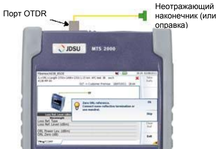
Рисунок 109 Опорное измерение для обнуления ORL
