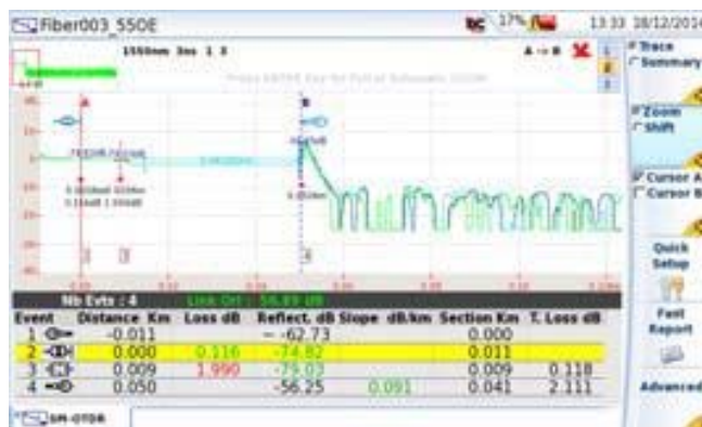
Рисунок 44 Пример наложенных рефлектограмм
