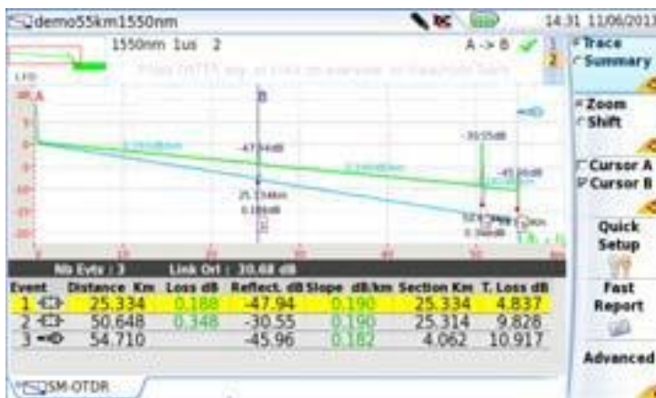
Рисунок 30 Пример результатов рефлектограммы с ExpertOTDR
