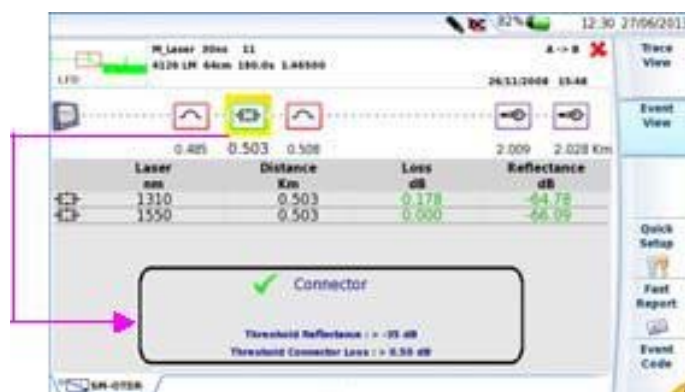
Рисунок 49 SmartLink: Просмотр событий
