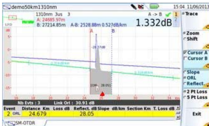
Рисунок 42 Результат измерения ORL
