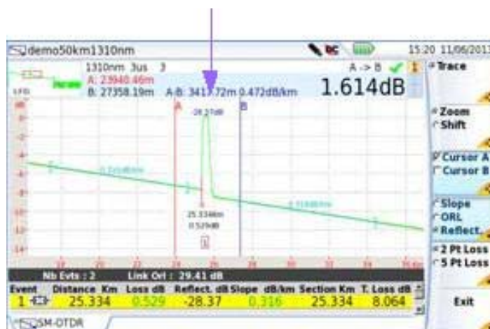
Рисунок 43 Измерение коэффициента отражения
