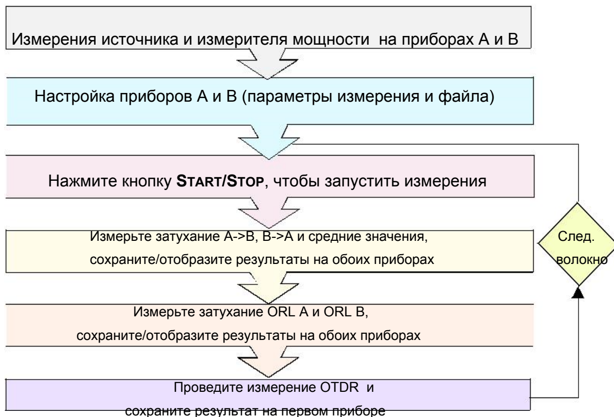
Рисунок 105 Тест при формировании сети/установке оборудования
