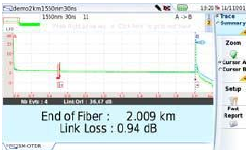
Рисунок 29 Пример результатов рефлектограммы с SmartTest
