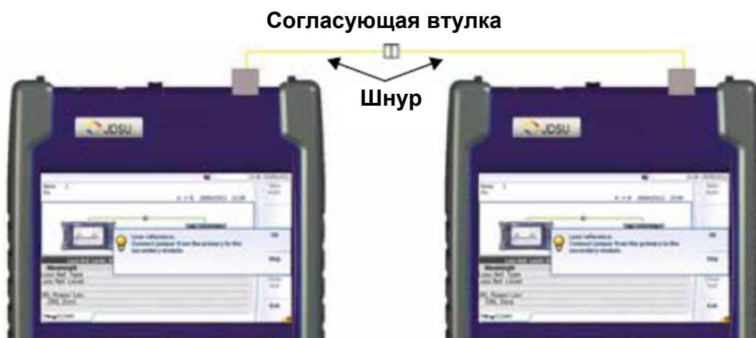
Рисунок 110 Опорное измерение затухания
