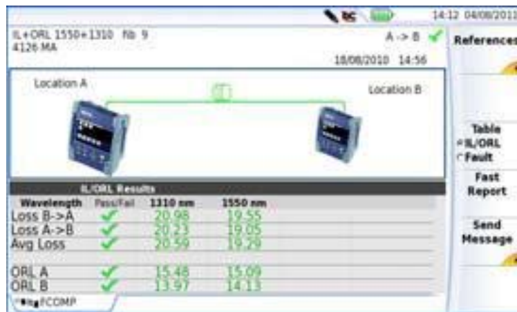
Рисунок 121 Результат Fiber View
