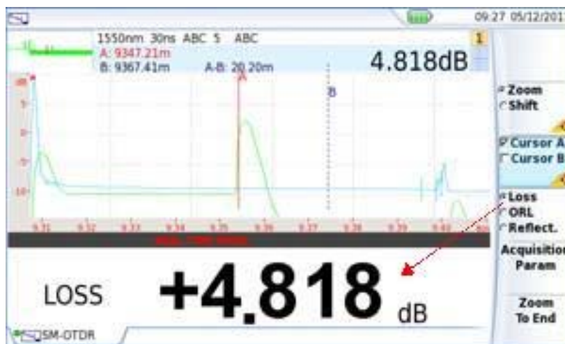
Рисунок 28 Пример измерение потерь
