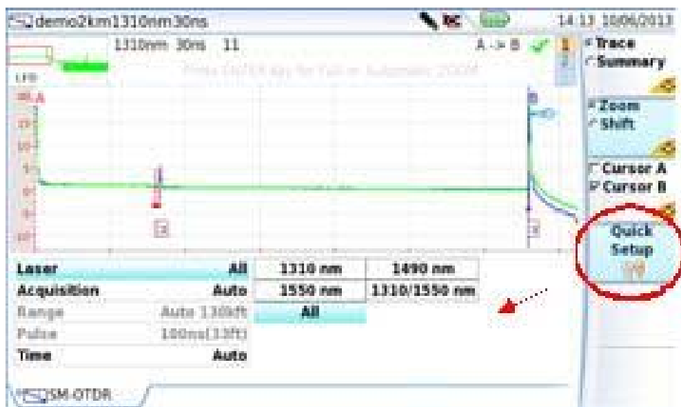
Рисунок 26 Страница результатов и быстрого меню установок (эксперт OTDR)
