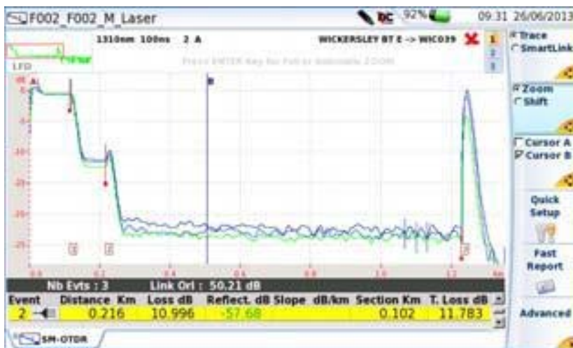
Рисунок 38 Рефлектограммы в наложении
