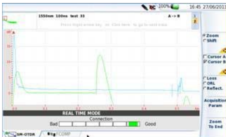
Рисунок 23 Пример выборки в реальном времени (с ExpertOTDR)
