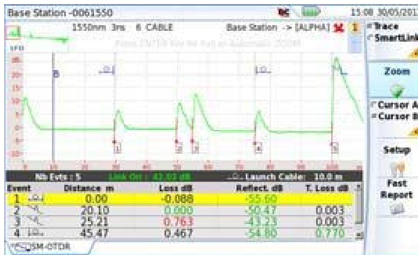
Рисунок 71 Рефлектограмма FFTA OTDR
