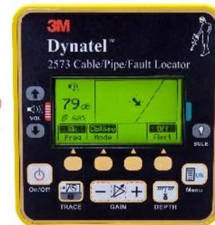
Режим визуализации трассы на дисплее: упрощение трассировки и минимизация ошибок в зонах большой концентрации подземных коммуникаций
