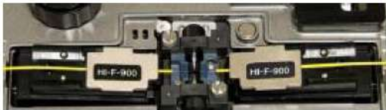
Сварка волокна с волокном
