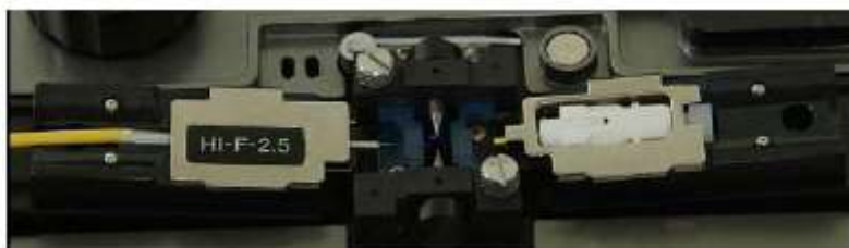
Сварка волокна с разъемом
