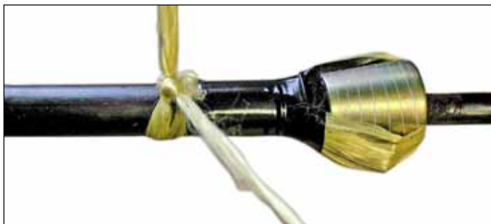
Рисунок 4.25 – Связывание пучков нитей узлом
