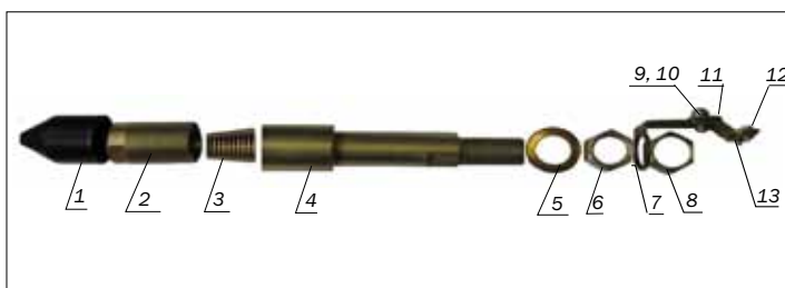
1 – Наконечник; 5 – Шайба; 11 – Скоба; 2 – Гайка внутренняя; 6, 8 – Гайка М18; 12 – Пластина; 3 – Конус внутренний; 7 – Кронштейн; 13 – Винт (2 шт.); 4 – Штуцер; 9, 10 – Винт М5 с шайбой Рисунок 4.14 – Штуцер узла ввода ОК
