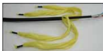
Рисунок 4.2 – Распределение арамидных нитей
