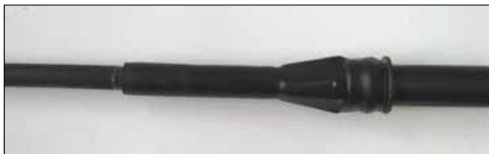
Рисунки 4.6 - Внешний вид смонтированного штуцера
