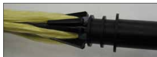
Рисунок 4.4 - Распределение нитей между лепестками штуцера
