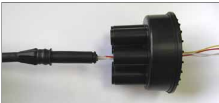
Рисунок 4.11 - Ввод ОК в сборе со штуцером в патрубок оголовника
