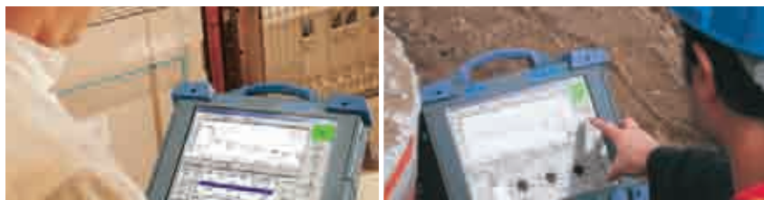
Рефлектометрические модули EXFO обеспечивают одинаковые результаты, как в полевых, так и в лабораторных условиях.
