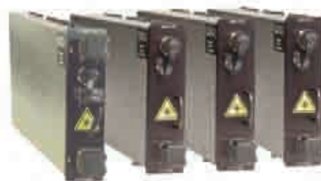
Рефлектометрические модули FTB-7200, FTB-7300, FTB-7400 и FTB-7500.
