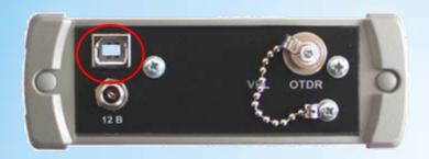
Обмен информацией между прибором и компьютером осуществляется стандартными программными средствами. После подключения к ПК прибор будет отображаться в системе как съемный диск VISA
