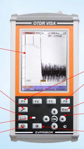
Назначение функциональных клавиш зависит от режима работы
