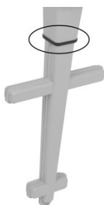
Рисунок 6. Наконечник (антенна) прибора-маркероискателя
